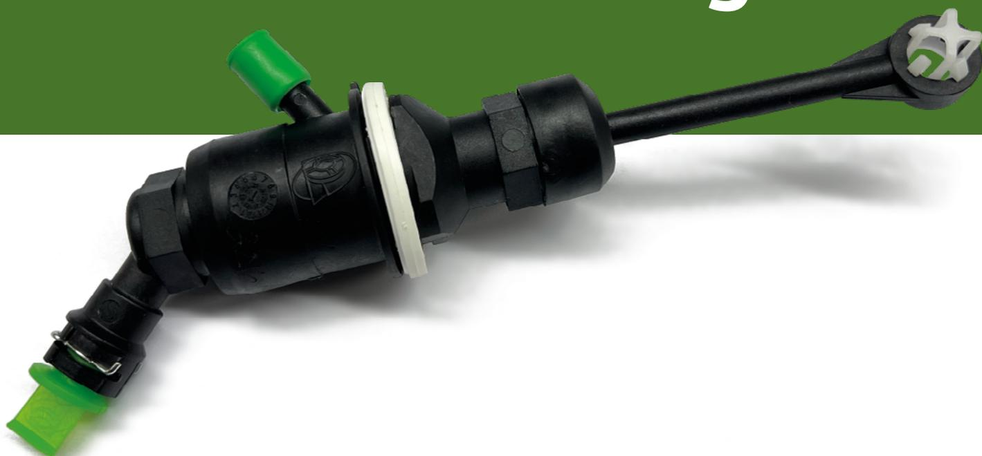
El cilindro maestro de embrague es una parte esencial del sistema hidráulico del embrague en un vehículo con transmisión manual. Su función principal es convertir la presión aplicada por el pedal de embrague en presión hidráulica, la cual se transmite al cilindro esclavo para operar el mecanismo de embrague. Aquí te explico las partes principales del cilindro maestro de embrague:
